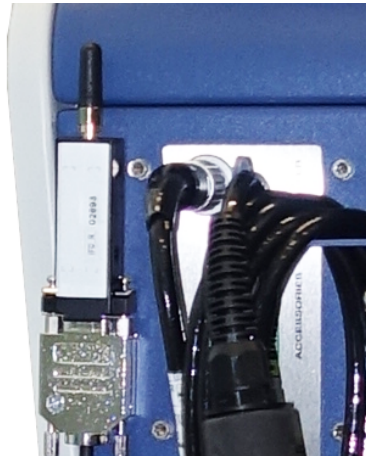
Fig. 21: Fixation de l'émetteur à l'aide de bande Velcro à un endroit libre
