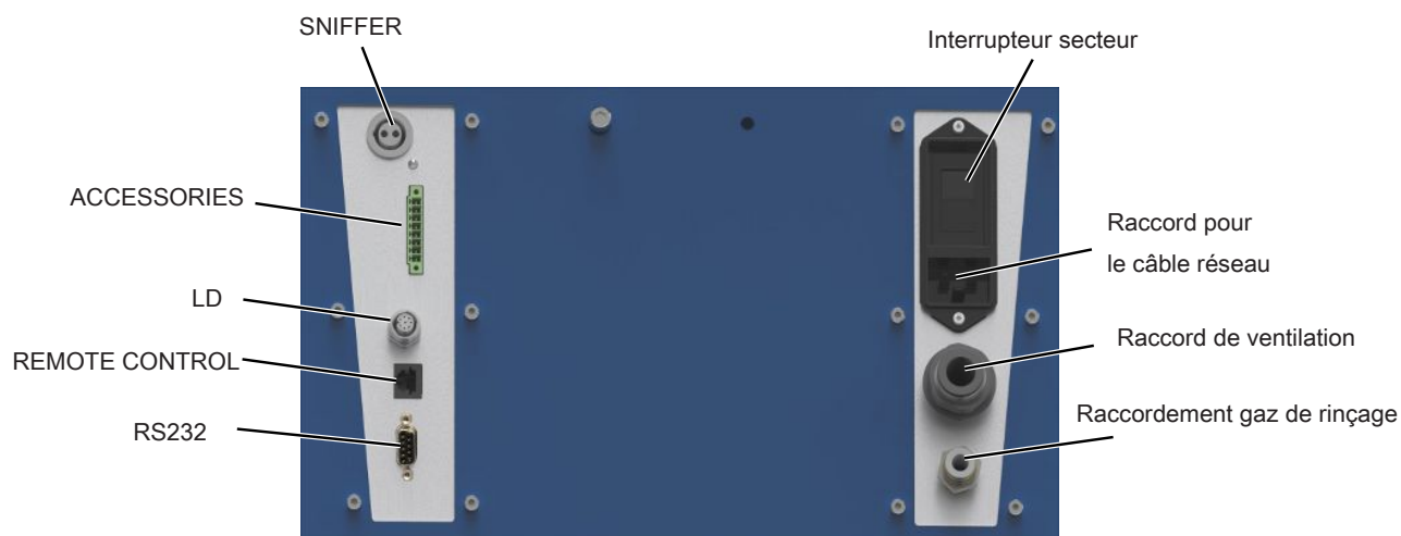
Fig. 6: Raccords pour accessoires et signaux de commande
