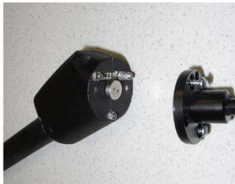
Fig. 19: Filtre Sinter dans la poignée de renifleur
