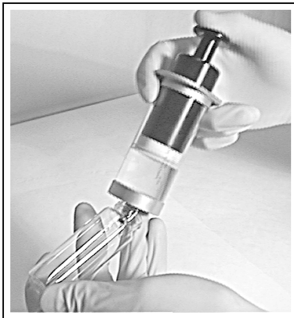
図 13-7 40 mL バイアルへのサンプルの注入
