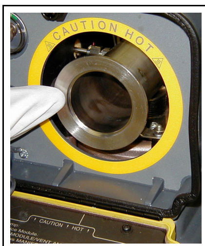
図 16-18 マニホールドのフランジのクリーニング
