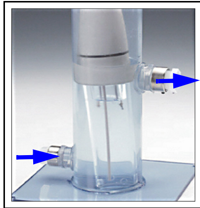
図 2-35 パージ容器の水の流れる方向
