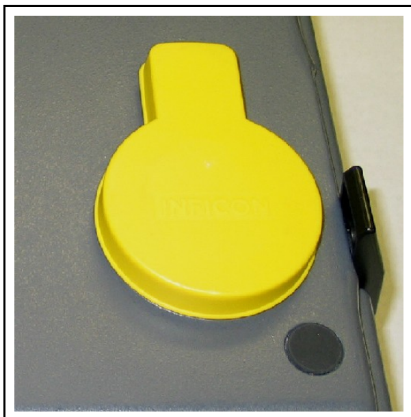
図 15-34 サービスモジュールのアルミ製保管用プラグに被せた黄色い保護カバー
