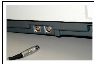
図 2-31 Y ケーブルを Situ プローブへ接続
