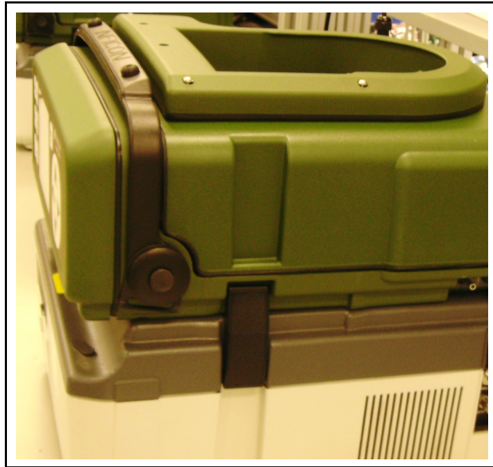
図 2-28 サービスモジュールのラッチを利用してサービスモジュールに固定された HAPSITE – 右側面より見る
