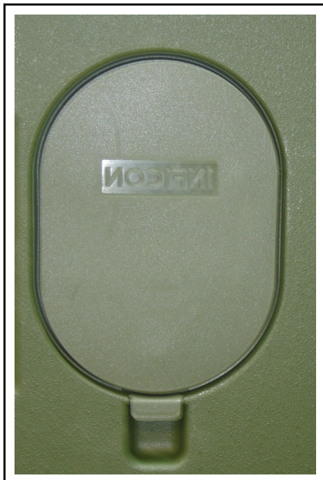
図 2-25 HAPSITE の底部から緑色のプラスチック製保護カバーを取り外します
