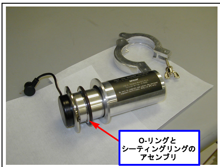
図 16-21 新しい NEG ポンプ
