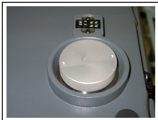
図 2-16 サービスモジュールに取り付けられた保管用アルミニウムプラグ
