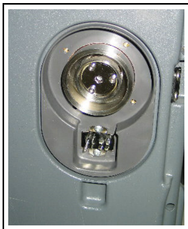
図 2-26 HAPSITE 底部から緑色のプラスチック製保護カバーを取り外した状態
