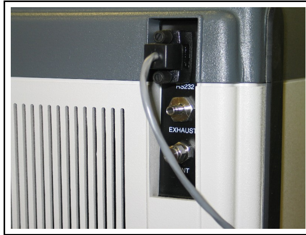
図 2-20 サービスモジュールの背面右端に接続された RS-232 通信ケーブル
