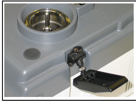
図 2-27 サービスモジュール – 右側面のラッチを示す
