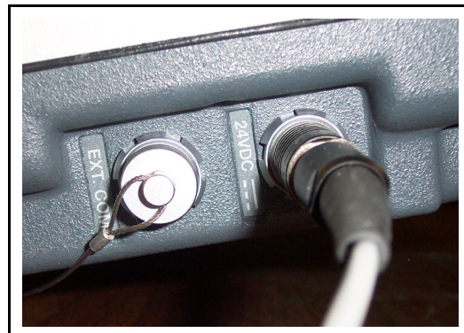
図 2-10 AC/DC 電源コンバータから HAPSITE への電源供給
