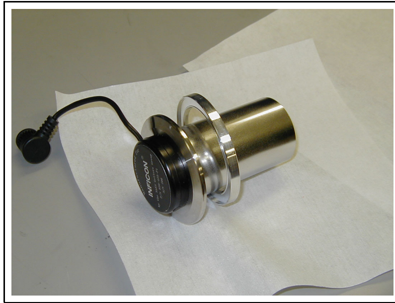
図 16-23 NEG ポンプのアルミ製ガスケット
