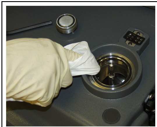
図15-29 サービスモジュールのゴム製 O-リングの汚れを不織布で拭き取る
