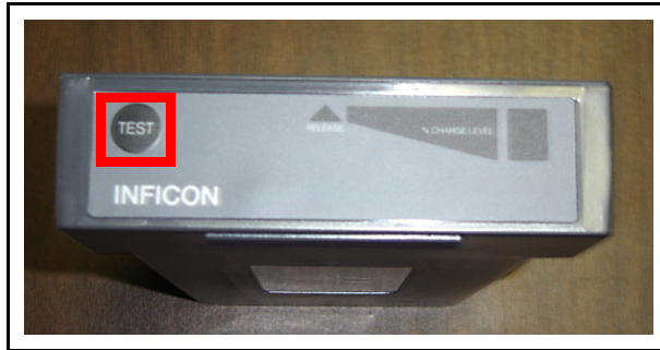
図 2-50 バッテリーのテストボタンと充電状態インジケータ
