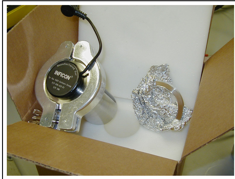
図 16-19 新しいNEG ポンプとアルミ製ガスケット
