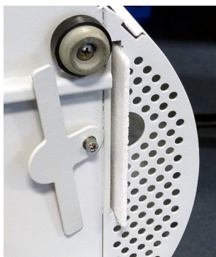
Abb. 47: Filtr powietrza w komorze filtra powietrza
