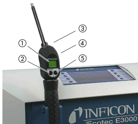
Abb. 4: Uchwyt: wyświetlacz i funkcje
