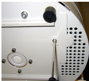
Abb. 46: Zwolnienie pokrywy filtra powietrza
