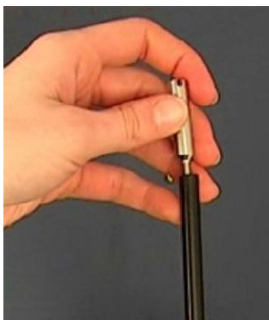
Abb. 8: Przykręcanie końcówki stożkowej ochronnej przed wodą
